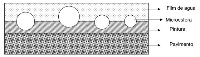
Spotflex: visibilidad efectiva con lluvia, las microesferas no se
